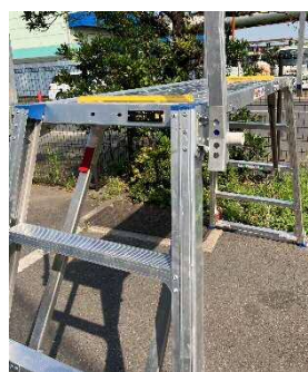
天板側面の妻側片面に設置
