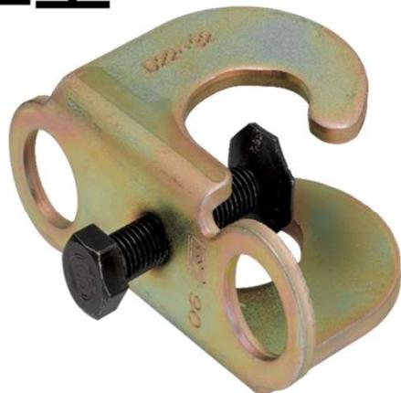
適応鉄筋径：D22～32
