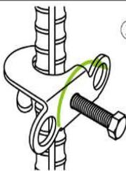
②矢印の方向に90°回転させ、ボルトを締め込みます。
