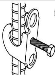
①鉄筋に対して縦向きに鉄筋フックをはめ込みます。
