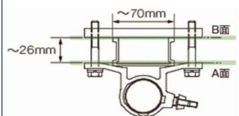
図のA面とB面が平行になるようにボルトを均等に締め込んでください。
