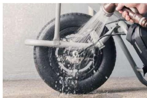
IP54 相当の防塵防水性能で雨天でも作業は可能
