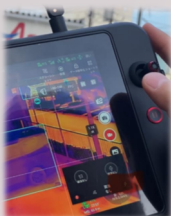
外壁点検(赤外線)
